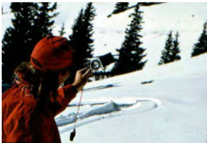
عکس ۶- همراه داشتن یک «انحراف‌سنج» ۲۴ به اندازه‌گیری زاویه شیب کمک می‌کند. (توسط: رُن بوکمن: Ron Bookman)
